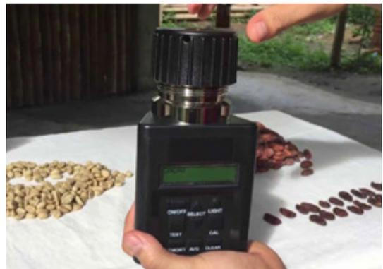
**Figura 4:** Ejemplo de medidor de Humedad de granos de cacao
